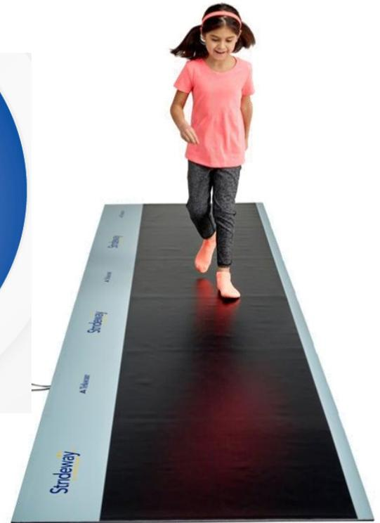
Wählen Sie eine anpassbare Länge von 1 - 5 Meter und eine örtliche Auflösung von 1, 2 oder 4 Messpunkten pro cm<sup>2</sup> !
